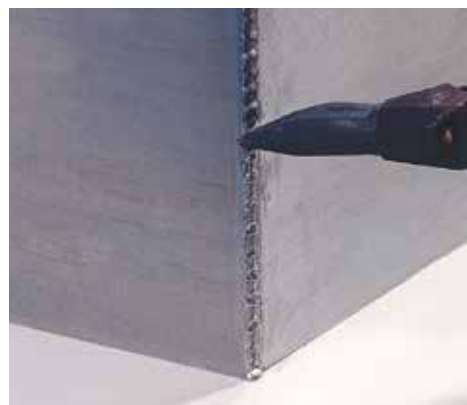
Soudo-brasage à gradins
