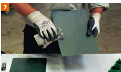
2 Traçage des valeurs de recouvrement.
