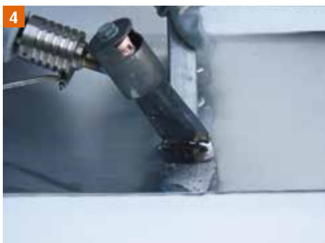
4 Réalisation d'un étamage (si épaisseur > 0,8 mm). Ensuite redépose du métal d'apport (si épaisseur > 0,8 mm).
