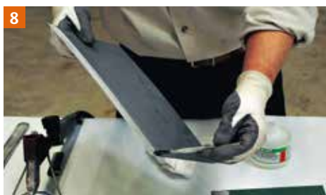
8 Décapage de la partie inférieure de l'élément supérieur (Deca VMZINC).
