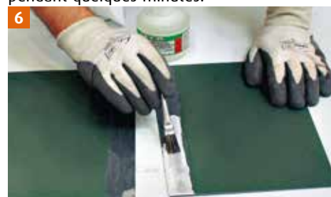
6 Premier décapage de la couche de prépatinage grise au Deca VMZINC.
