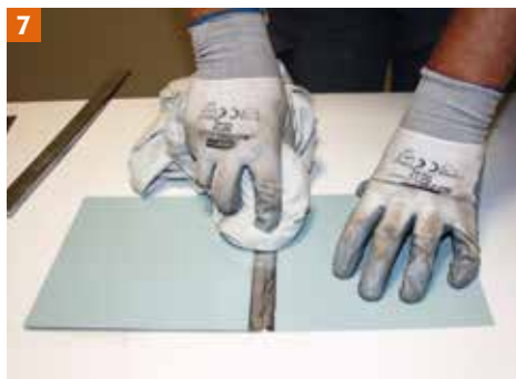
Nettoyage du soudo-brasage.
