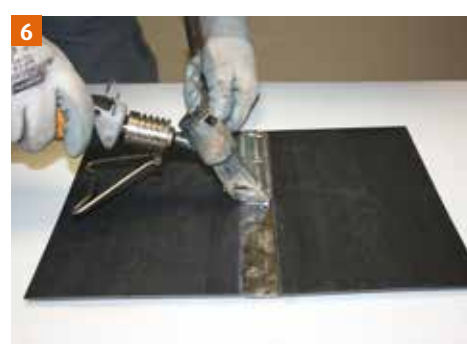
6 Appliquez du Zinn 7 sur la longueur de la soudure. Soudo-brasage des éléments.
