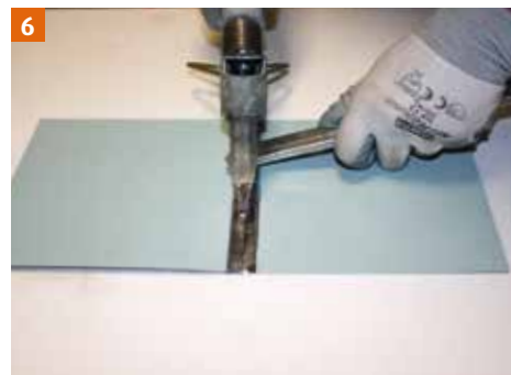
Appliquez du Zinn 7 sur la longueur de la soudure. Soudo-brasage des éléments.
