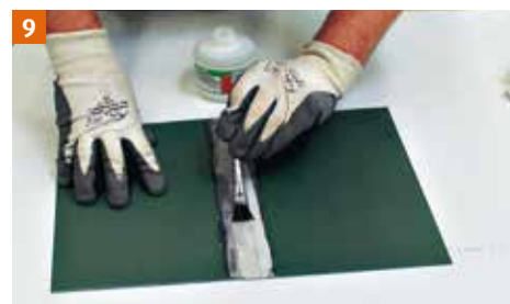
9 Appliquez localement du Zinn 7. Assemblez les 2 feuilles de zinc conformément au schéma des p 6 - 7.
