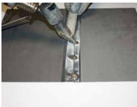
Pointage des éléments à soudo-braser
